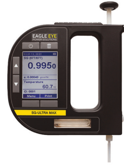
الشكل (14): مقياس كثافة سوائل إلكتروني.
