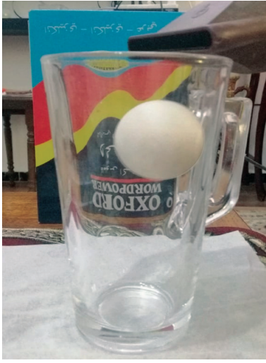
الشكلُ (26): ارتفاعُ كرةِ التنسِ في الهواءِ عندَ تسليطِ تيارِ هوائيٍّ فوقَ الكأسِ أفقيًا.
